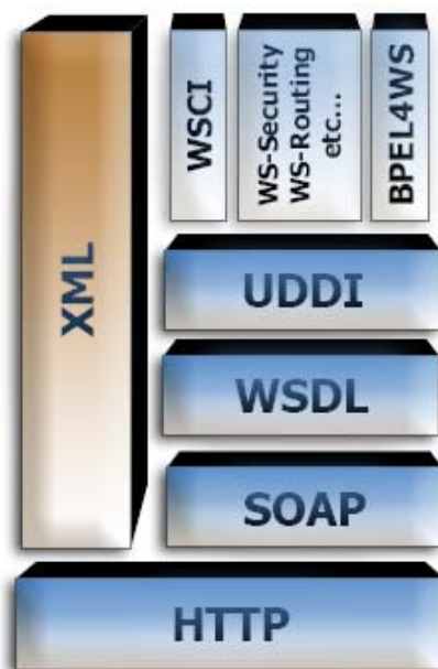
Figura 4.1: Nivelurile de standardizare ale serviciilor Web
